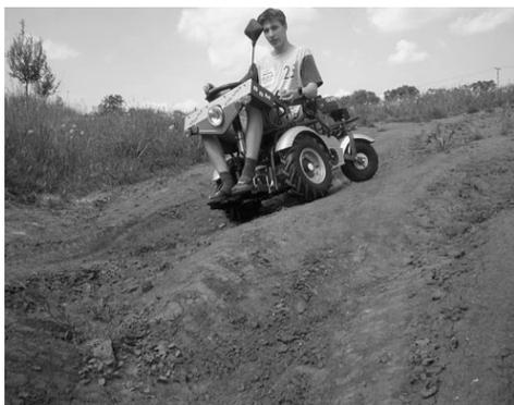
La conducción de estas sillas se realiza a través de controles de sencillo manejo, una mano para el acelerador-freno y la otra para el control de la dirección. La llave de contacto y los indicadores se encuentran en un tablero claramente visible. El usuario va confortablemente ubicado en un asiento ergonómico de respaldo alto por lo que el soporte del tronco y espalda están asegurados, detalle este importante para usuarios con un equilibrio deficiente.
